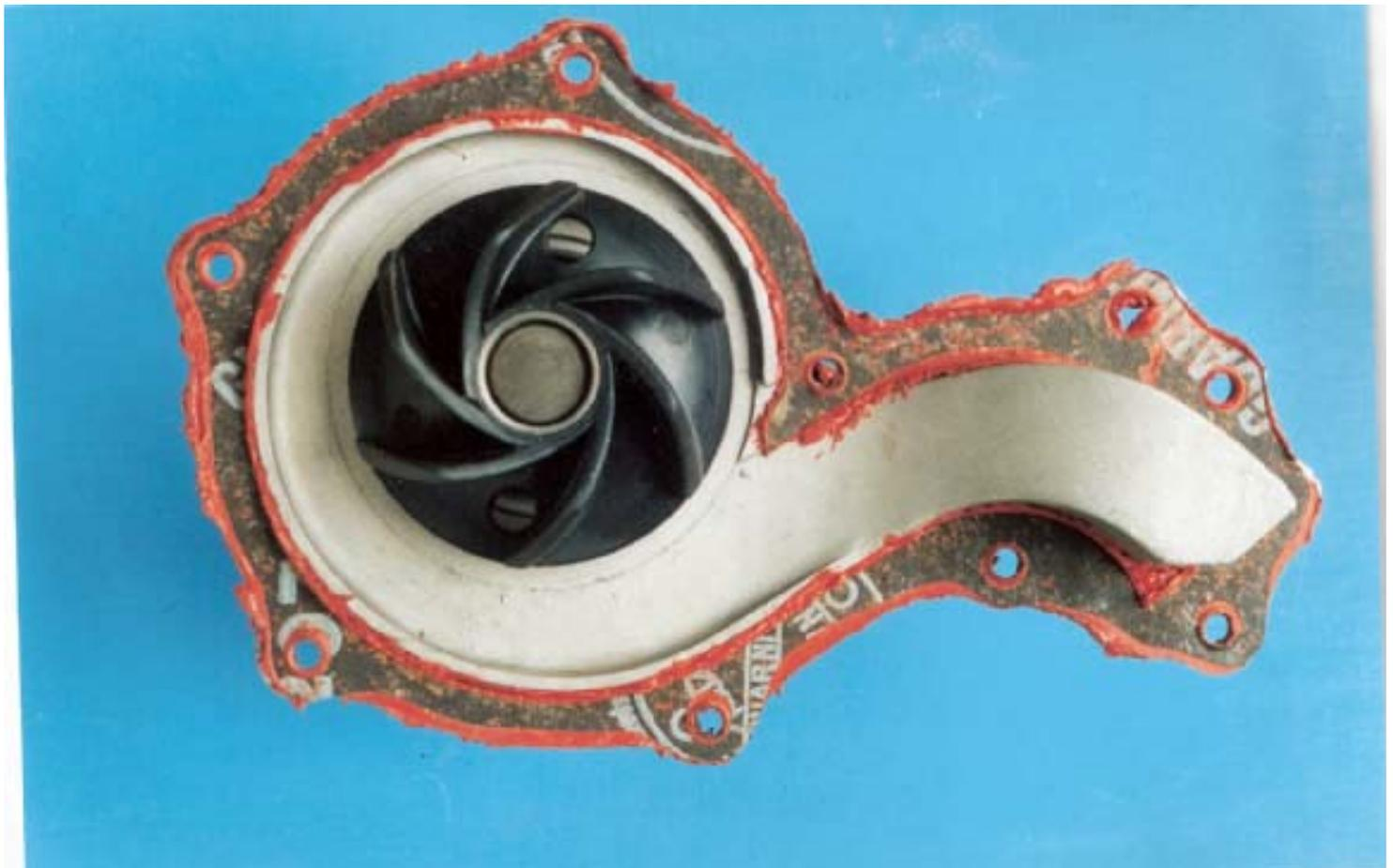
Foto 1: Bomba que ha trabajado con un refrigerante orgánico correctamente formulado y usado en la proporción exacta más un agua de buena calidad. No se observa ningún daño ni síntoma de corrosión en las partes ferrosas y de aluminio.
