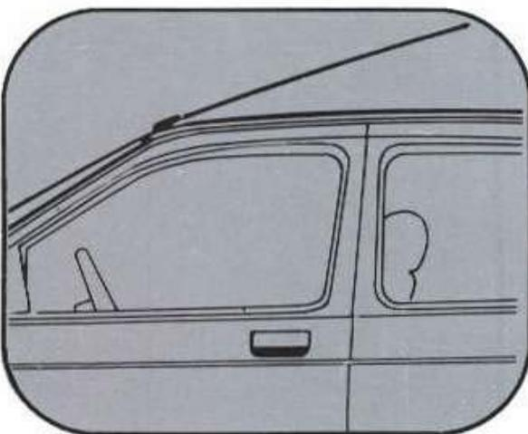
La antena de techo no es extensible, pero tiene tres posiciones angulares, las que se pueden lograr girando suavemente el mástil flexible sobre la base. La posición más próxima al techo es para aquellas ocasiones en que el automóvil es limpiado en lavaderos automáticos y a efectos de evitar
